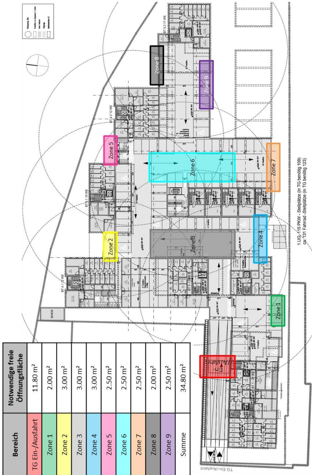
**Abb. 3.1:** Empfehlungen zu Position und freiem Querschnitt der für eine natürliche Lüftung der Tiefgarage erforderlichen Lüftungsöffnungen
