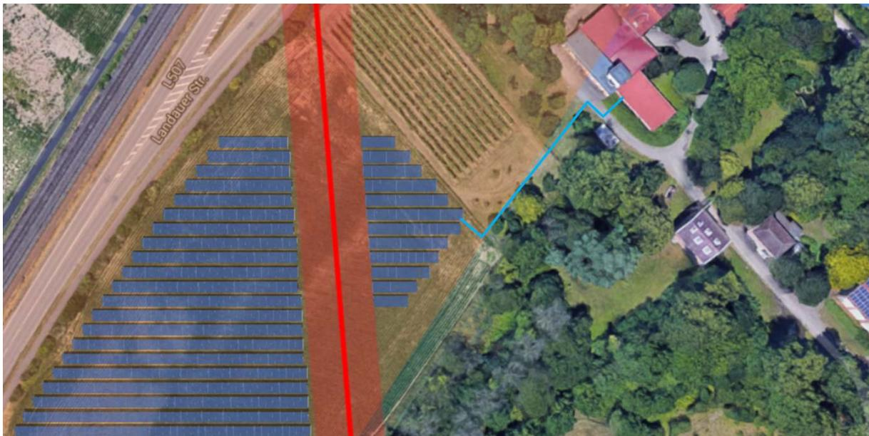
Abbildung 9: Schematische Darstellung Freiflächenanlage, 110m Streifen zur Bahnschiene (Orange), 20kV-Freileitung mit Schutzstreifen (Rot), Netzanschluss an Hauptverteilung Wasserwerk (Türkis)<sup>11</sup>
