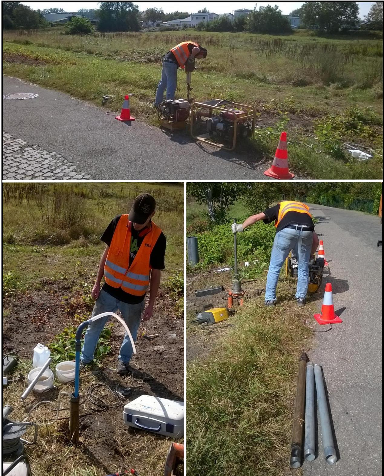
Abbildung 7: Rammkernsondierung zur Herstellung der temporären Grundwassermesstelle 2 (temp. GWM2) im Grundwasserabstrom aus Stahlrammfiltern, auf der Teilfläche der Fa. Höhl.
