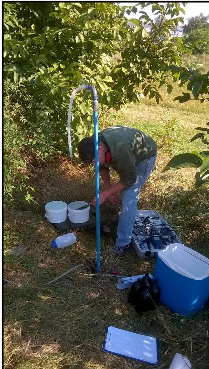
*Abbildung 6: Grundwasserbeprobung an der fertiggestellten temp. Grundwassermessstelle 1 im Anstrom der Altablagerung (im Hintergrund zu sehen).*
