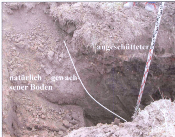
Abbildung 3: Abgebildet ist der Schurf S14. Erkennbar ist die Grenze zwischen dem natürlichen gewachsenen Boden und dem angeschütteten Deponiematerial. Der natürliche Boden besteht aus einem relativ homogenen stark sandigen Kies und weist eine heller braune Farbe auf. Das angefüllte Deponiematerial beinhaltet verschiedene Bauschuttreste und hatte insgesamt eine dunklere Farbe.
