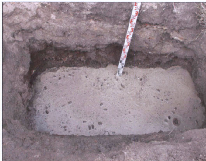
Abbildung 4: Abgebildet ist der Schurf S15. Die Grundwasseroberfläche liegt hier ca. 145 cm unter der GOK. Deutlich erkennbar sind die auf der Wasseroberfläche schwimmenden Flaschenkorken.
