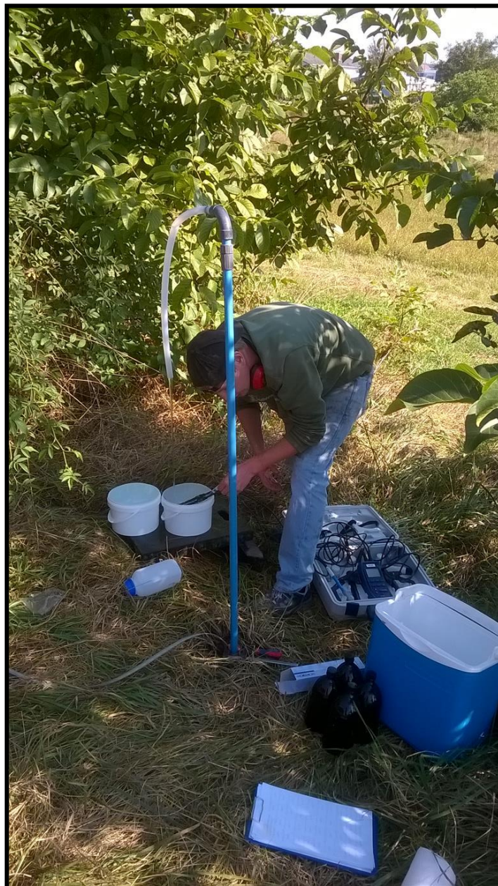
Abbildung 6: Grundwasserbeprobung an der fertiggestellten temp. Grundwassermessstelle 1 im Anstrom der Altablagerung (im Hintergrund zu sehen).
