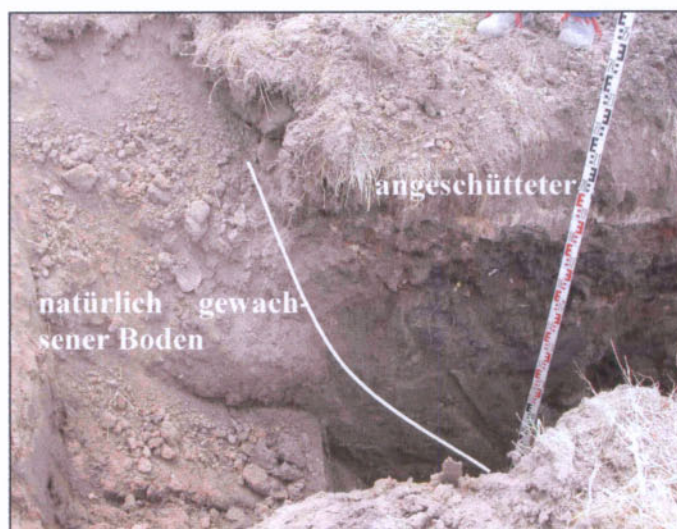
Abbildung 3: Abgebildet ist der Schurf S14. Erkennbar ist die Grenze zwischen dem natürlichen gewachsenen Boden und dem angeschütteten Deponiematerial. Der natürliche Boden besteht aus einem relativ homogenen stark sandigen Kies und weist eine heller braune Farbe auf. Das angefüllte Deponiematerial beinhaltete verschiedenen Bauschuttreste und hatte insgesamt eine dunklere Farbe.
