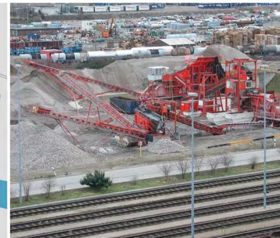
Boden- und Bauschutt-Recycling-Anlage
