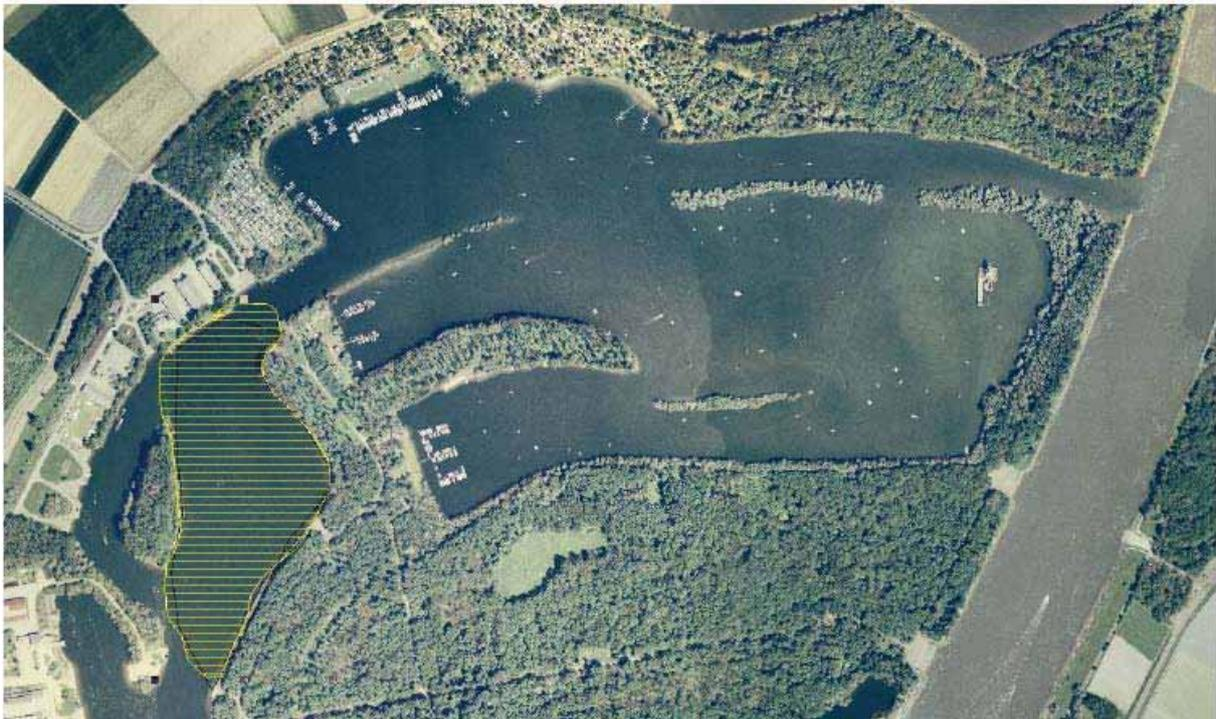
Abb. 9.7: Durch das Auffüllen der gelb gekennzeichneten, ca. 13 ha großen Fläche auf eine Zieltiefe von  $\leq 4$  m könnte am Angelhofer Altrhein das Flächenkriterium zum Erreichen des guten ökologischen Zustandes erfüllt werden.
